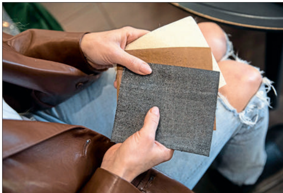
Des échantillons de cuir produits à partir de résidus de pommes. Un léger effluve de pommes s'échappe du textile.
